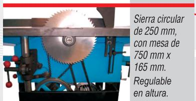
Sierra circular de 250 mm, con mesa de 750 mm x 165 mm. Regulable en altura.
