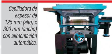
Cepilladora de espesor de 125 mm (alto) x 300 mm (ancho) con alimentación automática.
