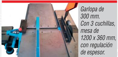
Garlopa de 300 mm. Con 3 cuchillas, mesa de 1200 x 360 mm, con regulación de espesor.
