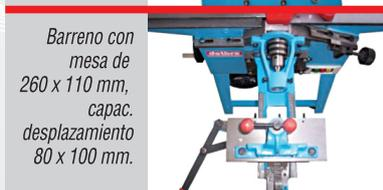
Barreno con mesa de 260 x 110 mm, capac. desplazamiento 80 x 100 mm.
